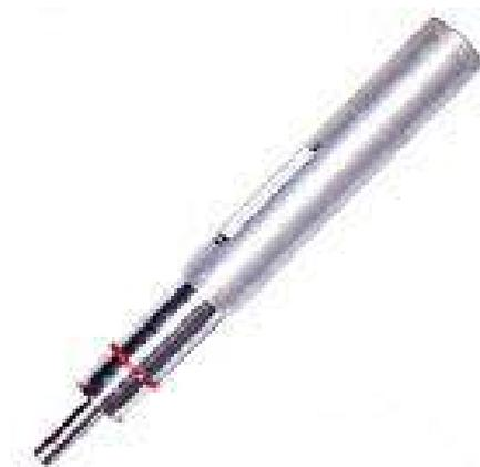
Il penetrometro è utilizzato per la descrizione dettagliata delle terre nel corso di un sondaggio (prove di cantiere). Con il penetrometro si ricava la coesione non drenata  $C_u$ . Si può verificare se la consistenza è molle, semi-plastica, plastica o dura.
