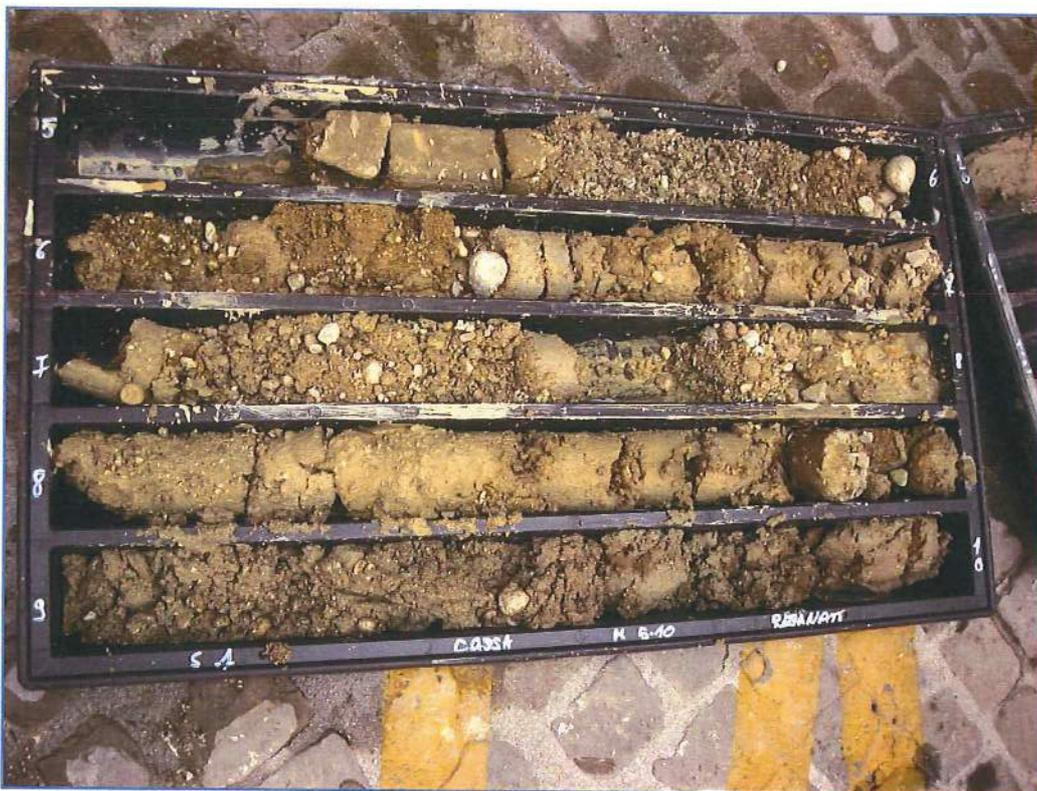
Foto n. 2: Particolare dei campioni di terreno estratti in SM1 per ogni metro. Da 5.00 a 10.00m
