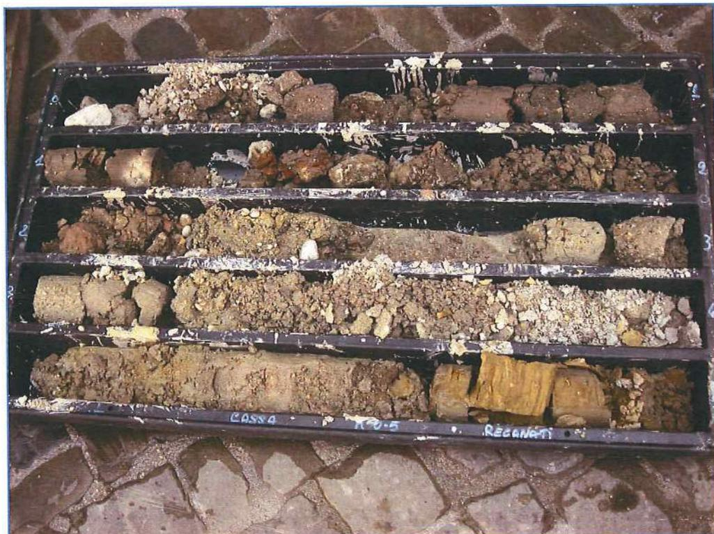
**Foto n. 2: Particolare dei campioni di terreno estratti in SM1 per ogni metro. Da 0.00 a 5.00m**
