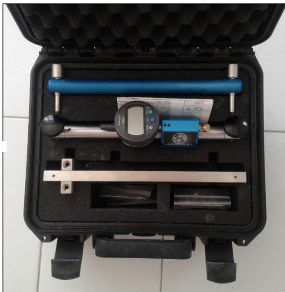
*Fig. 4 - Deformometro digitale di precisione "Mytutoio".*
