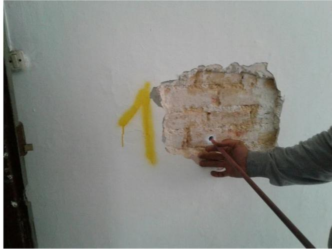
*Fig.6 – Esempio di esecuzione Prova Endoscopica.*
