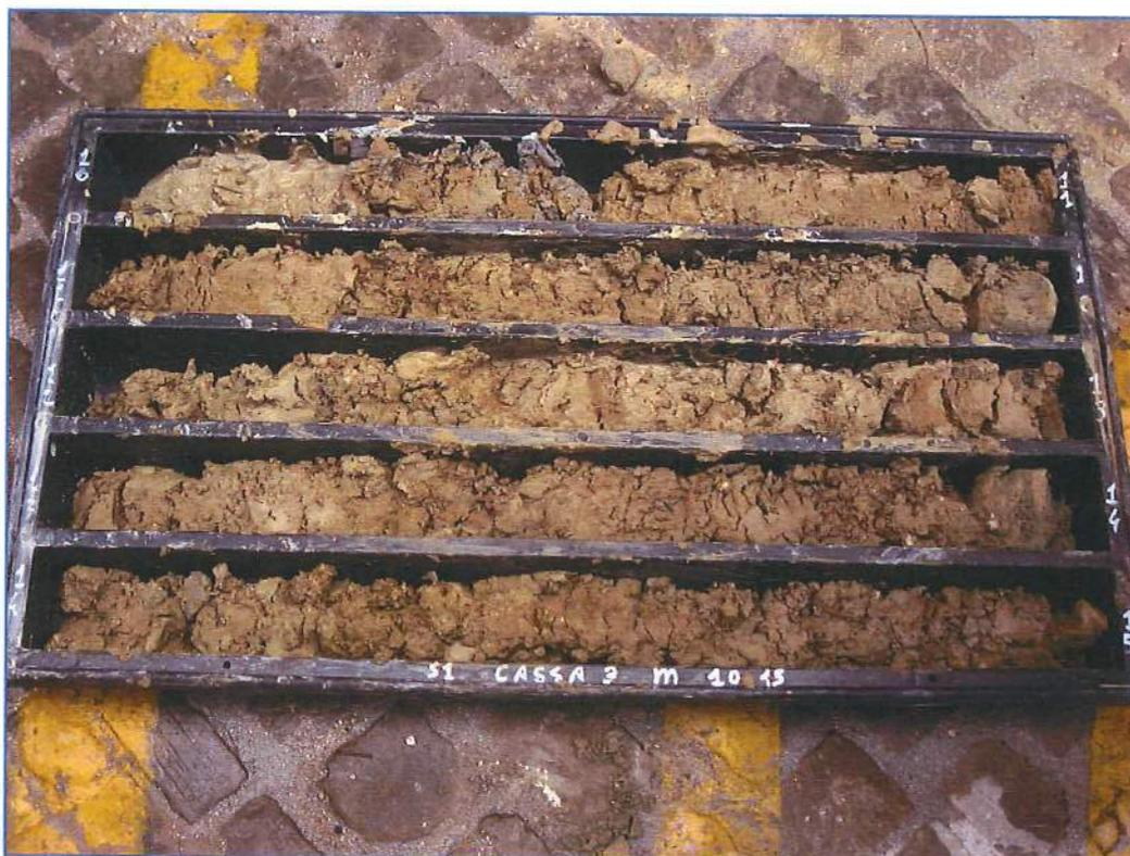
Foto n.3 : Particolare dei campioni di terreno estratti in SM1 per ogni metro. Da 10.00 a 15.00m
