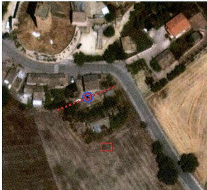
Figura 2 – ubicazione indagine Tromino e centro e direzione dello stendimento MASW realizzato.
